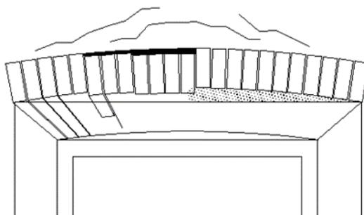
**A05055** Consolidamento di piattabande di aperture esistenti su muri di spina, collocate a ridosso di pareti perimetrali esposte e tali da ridurre la capacità strutturale del martello murario. L'operazione prevede la realizzazione di perforo armato alla quota inferiore del terzo medio, atto ad assumere la funzione di tirante alle reni dell'arco di scarico spontaneo generato sull'estradosso dell'apertura. Intervento da realizzare previa puntellatura e solleva-
