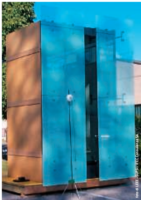
Modello in scala 1:1 per la valutazione delle prestazioni energetiche della facciata
